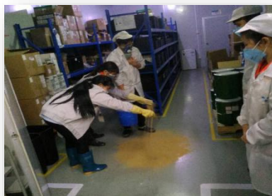
用沙子填盖泄漏化学品
